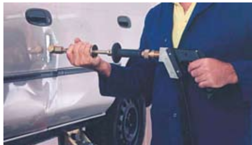
スポットハンマーはガンに取付けることができ、作業を迅速に行えます。
