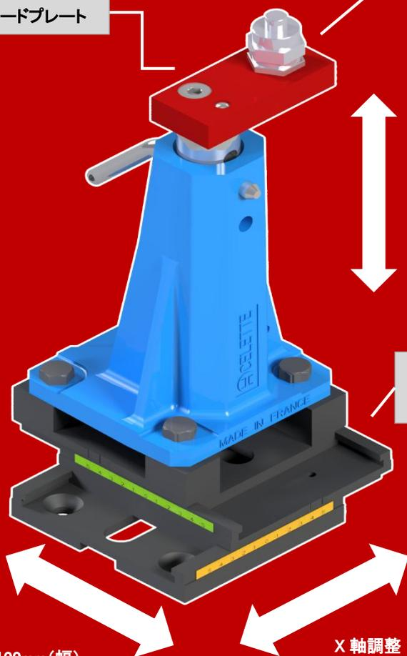
Z 軸調整(高さ) - タワーとピストンの構成を選ぶことで上下 10mm の調整が可能
